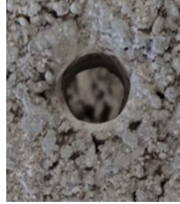
Отвір після свердління спеціалізованим буром
