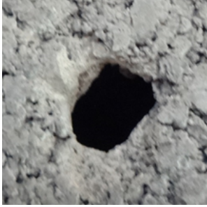
Отвір після свердління звичайним буром
